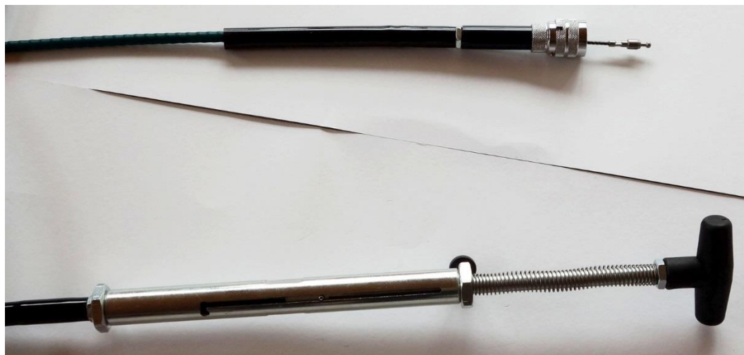
Abb. 3b Der maximale Ausfahrweg beträgt ca. 185 mm
