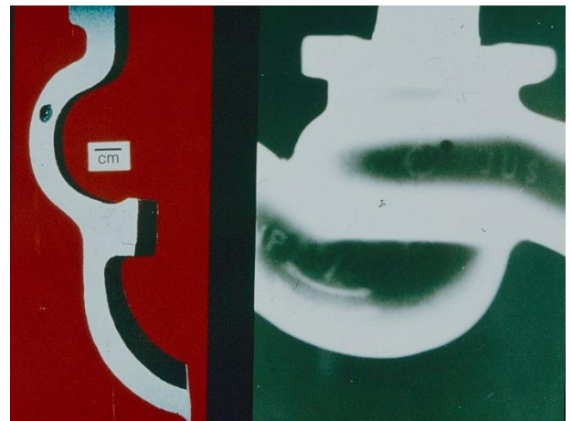
Nichtmetallischer Einschluß im Ventilgehäuse aus GS-C25
